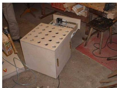
Grundfläche mit Kompressor und Schublade für elektronische Steuerung und Anschlussmöglichkeiten für Ventile und Schläuche
